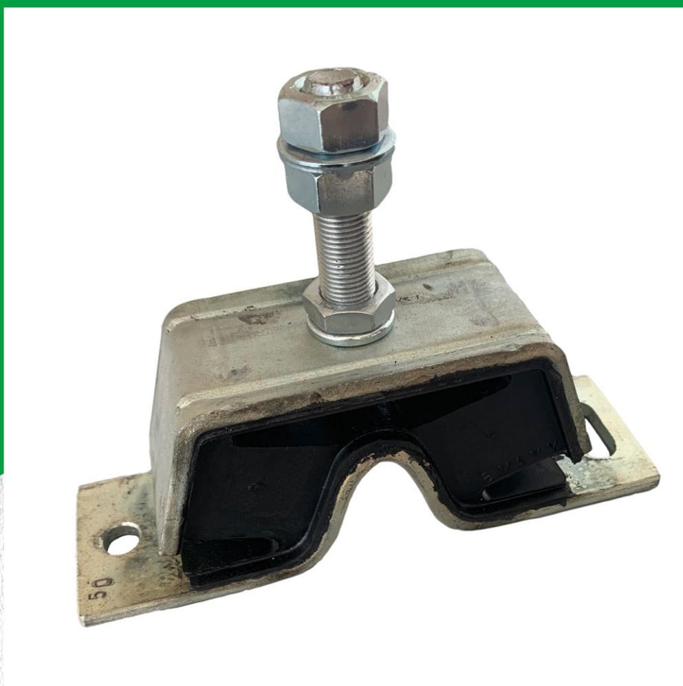
Supporto antivibrante elastico composto da due parti metalliche, gomma antivibrante ed un perno superiore, ancorato sulla piastra che ne consente l'installazione, corredato di rondelle e dadi.
