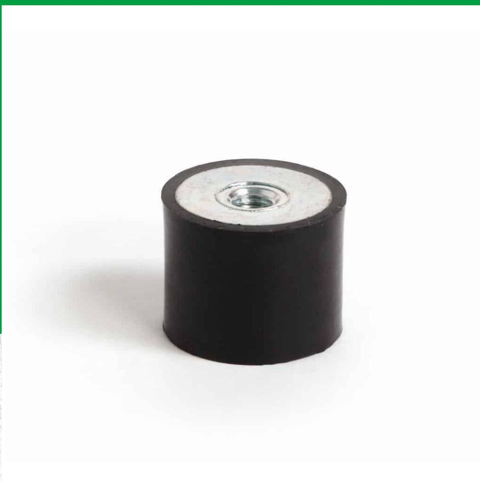
Sono costituiti da un cilindro in gomma naturale e da una armatura in acciaio zincato. Caratterizzati da una elasticità radiale superiore a quella assiale, possono lavorare a compressione oppure a taglio a secondo delle condizioni di montaggio. È l'antivibrante più semplice, di ingombro minimo e viene catalogato in base al tipo di fissaggio e alle dimensioni delle parti filettate.
