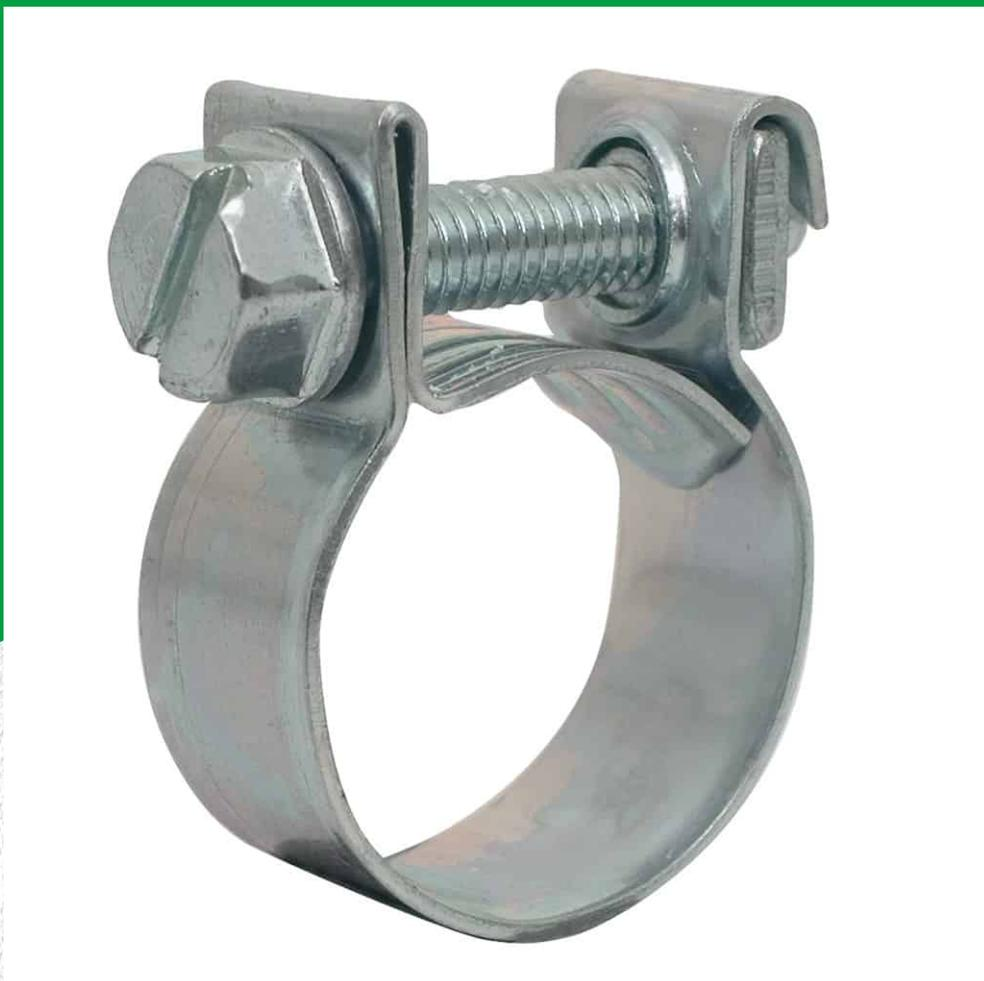
Il collare benzina ha un nastro a bordi rialzati per non danneggiare il tubo. La linguetta inferiore è munita di rinforzo. Un altro dettaglio pratico è la testa esagonale della vite, dotata di intaglio e adatta per l'utilizzo di un cacciavite flessibile. È particolarmente indicato per tubi di piccolo diametro e di spessore ridotto.
