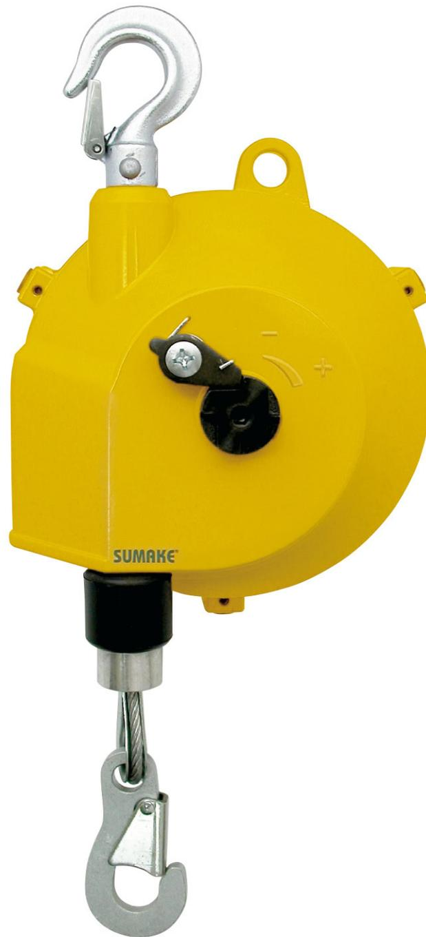
I bilanciatori industriali SUMAKE sono progettati con un meccanismo a spirale che garantisce un funzionamento fluido e controllato. L'aumento del diametro della vite è compensato da una maggiore forza della molla, assicurando un equilibrio costante della forza in uscita. Questo consente all'operatore di posizionare e mantenere lo strumento esattamente nel punto desiderato, riducendo lo sforzo e migliorando l'ergonomia durante l'uso.
