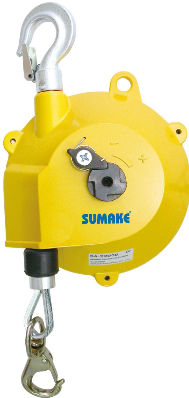
Il bilanciatore industriale è progettato con un meccanismo a spirale che garantisce un funzionamento fluido e controllato. L'aumento del diametro della vite è compensato da una maggiore forza della molla, assicurando un equilibrio costante della forza in uscita. Questo consente all'operatore di posizionare e mantenere lo strumento esattamente nel punto desiderato, riducendo lo sforzo e migliorando l'ergonomia durante l'uso.
