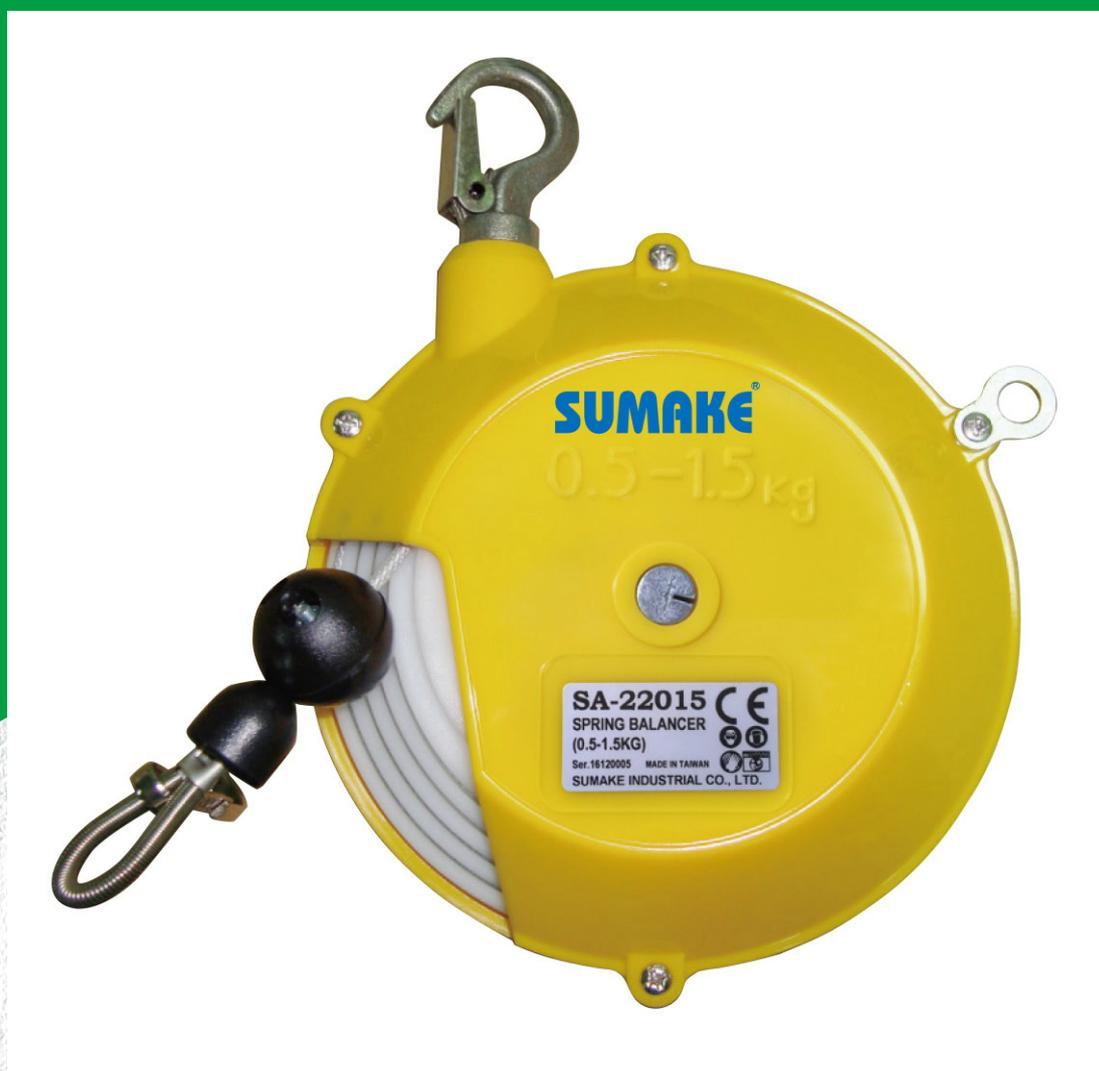
Il bilanciatore industriale è progettato con un meccanismo a spirale che garantisce un funzionamento fluido e controllato. L'aumento del diametro della vite è compensato da una maggiore forza della molla, assicurando un equilibrio costante della forza in uscita. Questo consente all'operatore di posizionare e mantenere lo strumento esattamente nel punto desiderato, riducendo lo sforzo e migliorando l'ergonomia durante l'uso.
