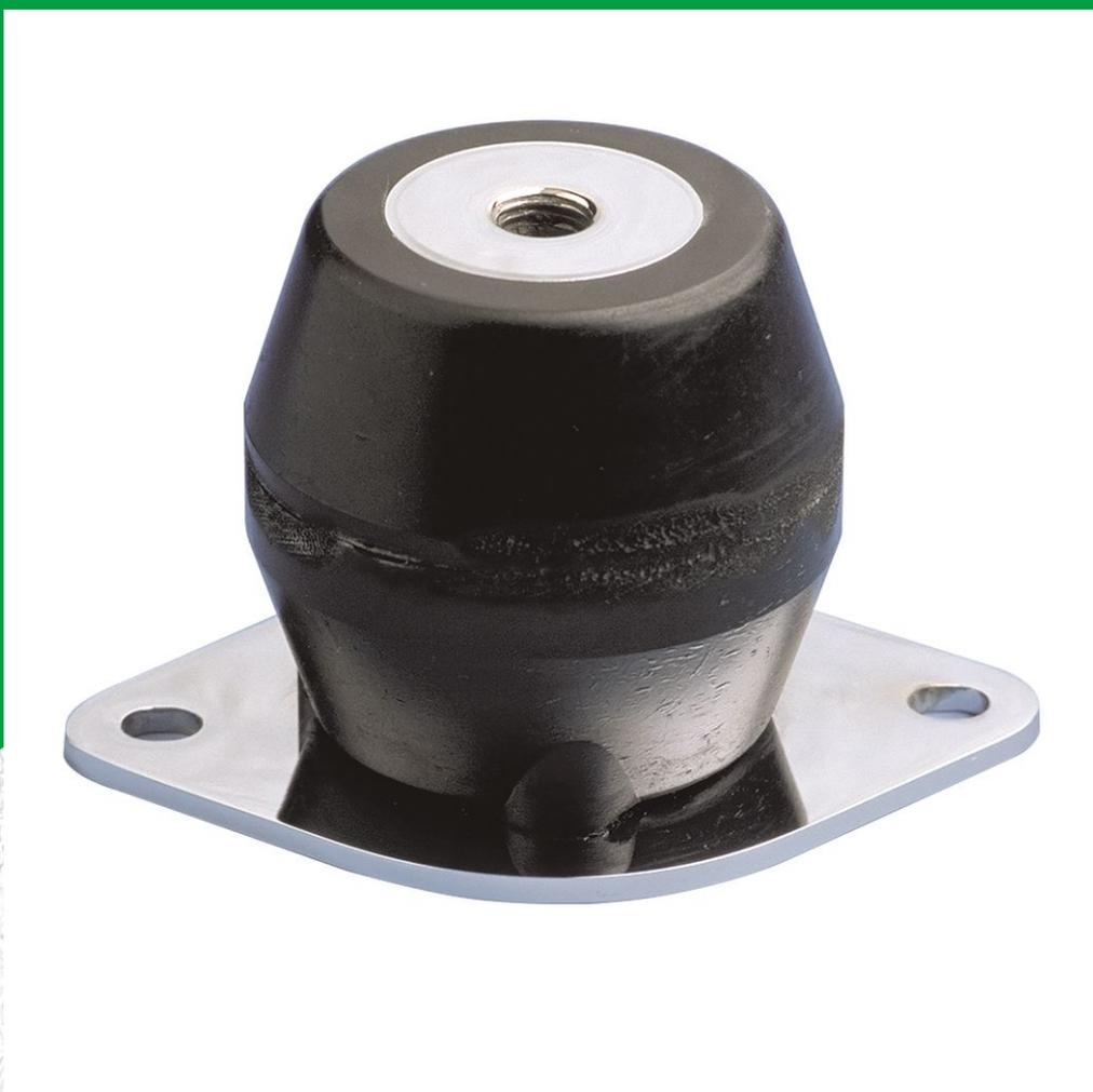
I supporti antivibranti Evidgom® sono costituiti da due membrane coniche spesse, unite alla base in modo da costituire una struttura elastica. Il particolare design di questo antivibrante gli conferisce grande elasticità assiale, frequenza propria molto bassa e al contempo svolgono la funzione di paracolpi in caso di shock o di sovraccarichi accidentali.
